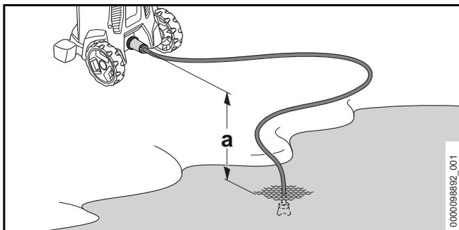
Para permitir que a água seja aspirada, a diferença de altura entre a lavadora e a fonte de água não deve exceder a altura máxima de sucção (a), 19.
