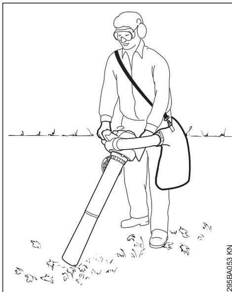
Der Saughäcksler ist für Zweihand-Bedienung ausgelegt. Er muss von der Bedienungsperson mit der rechten Hand am Bedienunggriff und mit der linken Hand am Griff des Gehäuses getragen werden.
