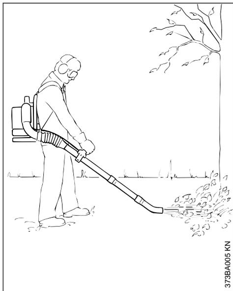
A máquina é levada nas costas. A mão direita conduz o tubo soprador no cabo de manejo, mesmo para canhotos.
